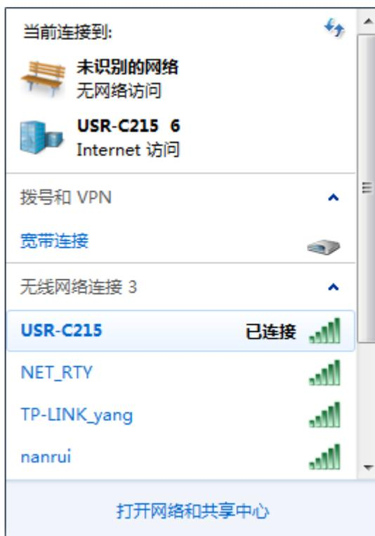
(2) 选择连接到此服务器, 密码 12345678, 连接成功后就可以正常使用本仪器。
