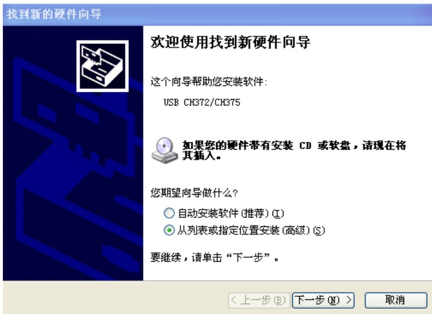
12.1.2 然后选择“在这些位置上搜索最佳驱动程序”，勾选“在搜索中包括这个位置”，在下面的地址上输入软件光盘所在的光驱盘符。完成后选择“下一步”。
