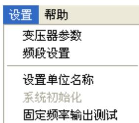
11.1.3.1 变压器参数，选择此项目后，会打开一个变压器各项参数的对话框，设置好各个参数后，按“确认”键保存输入数据，按“取消”键放弃输入数据，按“写入数据文件”键则将此变压器参数写入到已选择的历史曲线文件中，覆盖掉这些文件以前的变压器参数。（此功能是针对在变压器现场测试时，临时简单设置了变压器参数，再测试完成后重新想修改已保存的变压器参数的情况。）
