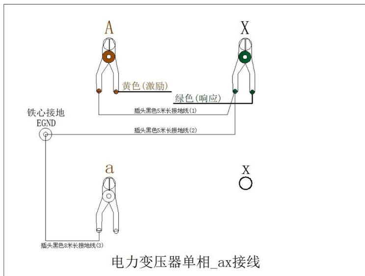
1. 测量系统共一点接地取变压器铁芯接地。
