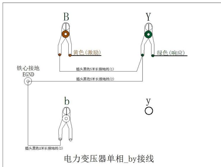
1. 量系统共一点接地取变压器铁芯接地。
