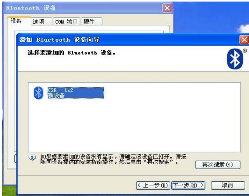
4. 点击下一步进行设备的配对，此时会要求填入密码。串口蓝牙。
