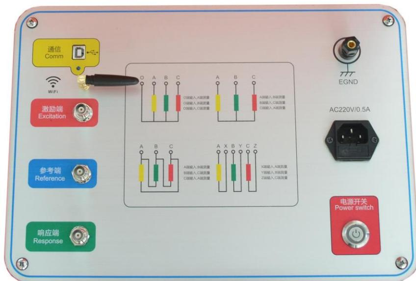
（变压器绕组变形测试仪面板图）
