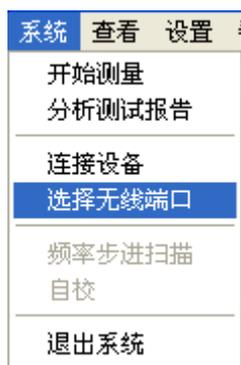
在无线测试模式中，如果出现因为无线蓝牙信号中断而系统无反应的时候，请关闭本软件系统和仪器设备电源，重新打开仪器设备电源和软件系统再进行测试。
