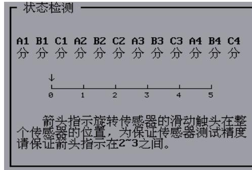
在这个界面下断口输入如果是悬空，液晶显示“分”，如果断口对地短接，则显示“合”。所以分别把各个断口对地（面板金属接地柱）短接一下，观察液晶显示器上端的端口状态显示的变化，来确定仪器断口时间通道是否正常。
