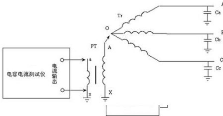
图十一 变压器中性点测量方法
