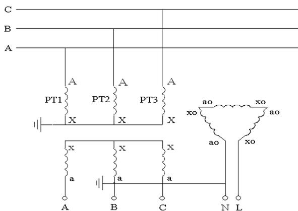
图五 B相接地方式
