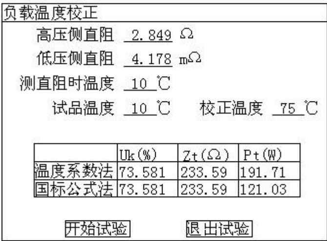
图 13 负载结果温度校正页面
