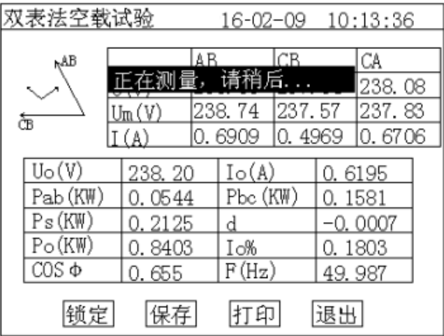
图 9 空载损耗正在测量计算页面
