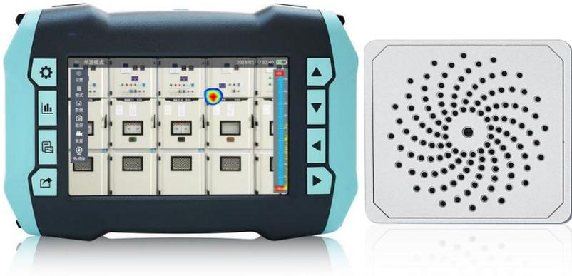
声纹成像定位仪利用麦克风阵列技术采集声纹数据，结合高清摄像头实现声纹的定位。利用纹束形成实现声纹定位技术分析后得到声纹分布数据，再将声纹分布数据与视频进行融合生成声像云图并在显示屏上动态展现。
