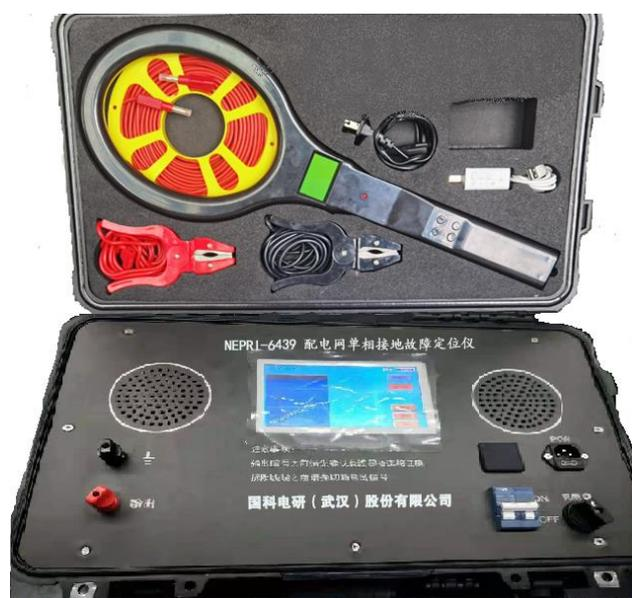
图 1 NEPRI-6439 型配电网单相接地故障定位仪
