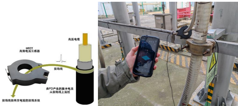
HFCT 接线方式及使用方法
