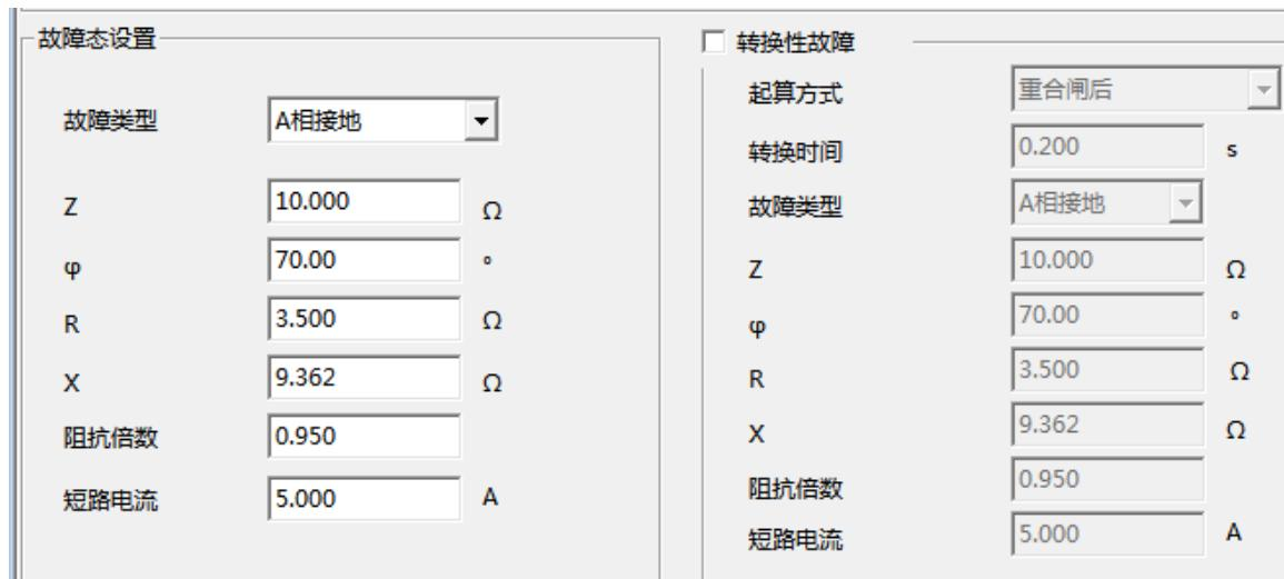
图 10-2 整组试验故障参数设置界面
