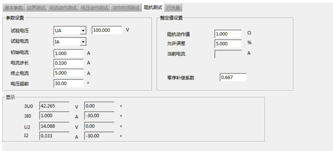
图 12-5 功率方向阻抗测试界面
